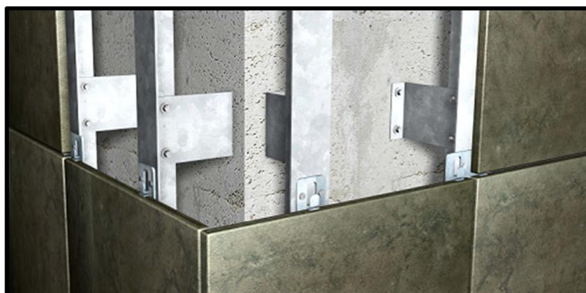
**Foto 30 - Sistema de Fixação de Fachada Ventilada**
